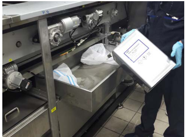
作業性を考慮した引き出しタイプの洗浄液タンク
