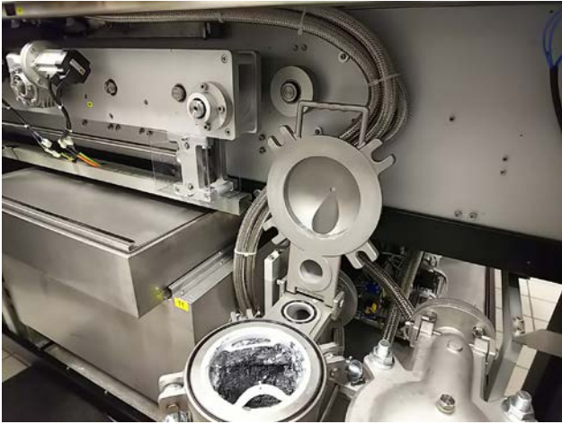
装置内部（フィルター部分）
